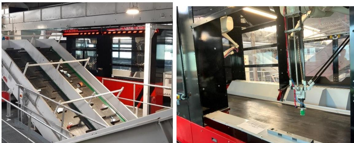
Figure 52 : Robot de tri WASORIA - Waste Robotic (centre de tri Semardel, Vert-le-Grand)
