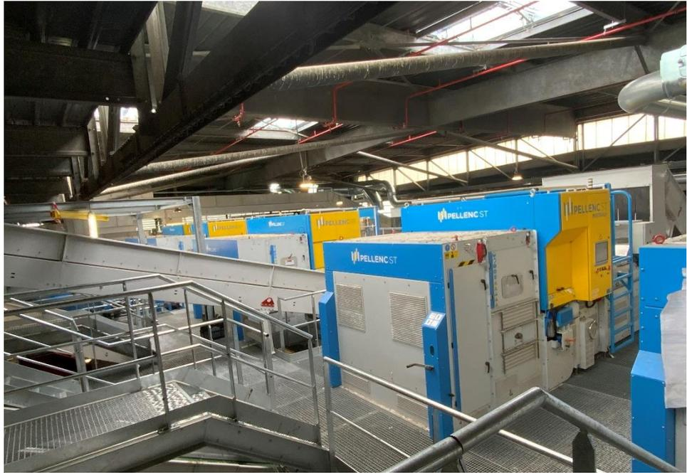
Figure 63: Machines de tri optique sur le site de SERIVEL
