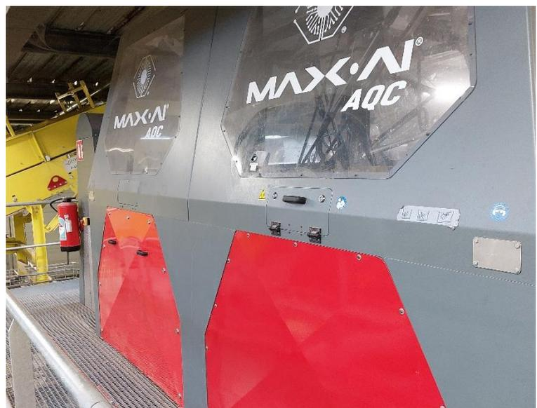
Figure 29: Trappe de changement de ventouse (source MAX AI)
