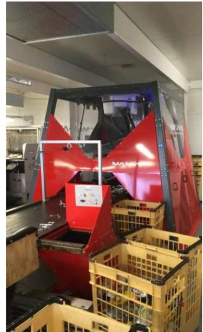
Figure 24: MAX AI dans une cabine de tri CS (source MAX AI)
