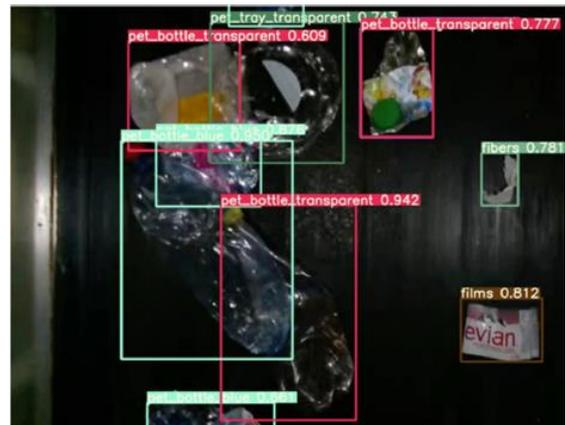
Figure 13 : Identification des objets (segmentation Recycleye)
