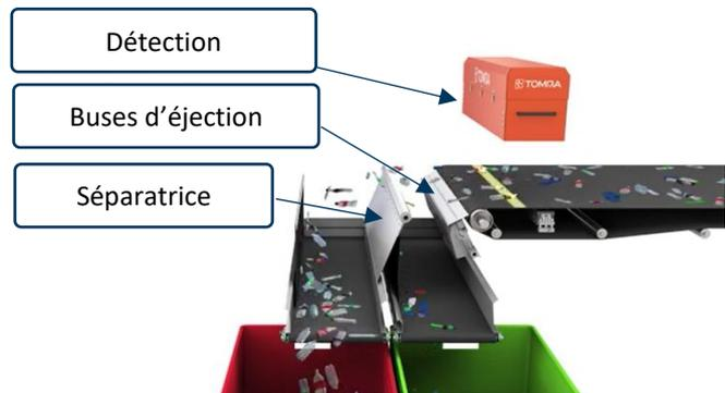
Figure 7: Principe de fonctionnement d'un tri optique (Source TOMRA)
